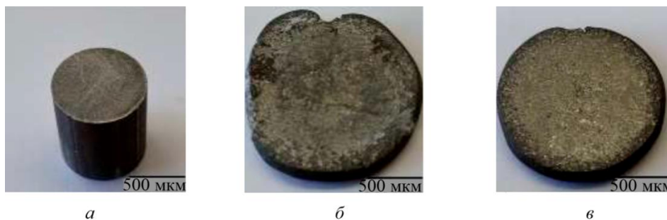
Рис. 1. Образец до испытания (а); образец № 1 после испытания (б); образец № 2 после испытания (в)
