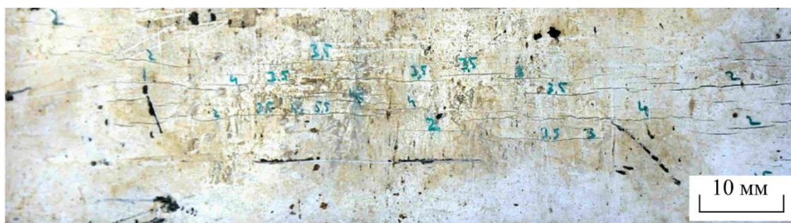
Рис. 2. Трещины, обнаруженные на темплете
