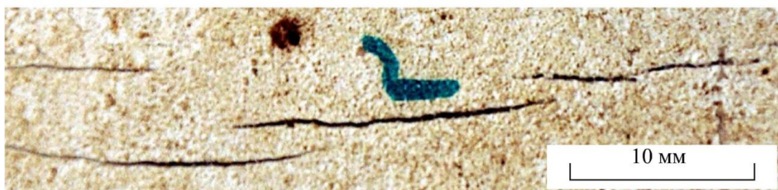
Рис. 7. Параллельное развитие трещин без объединения
