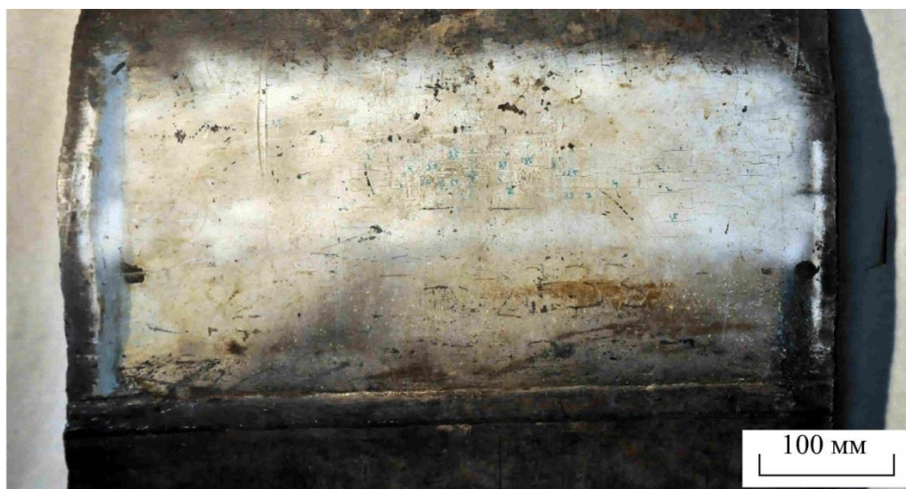
Рис. 1. Темплет с трещинами из трубы магистрального газопровода
