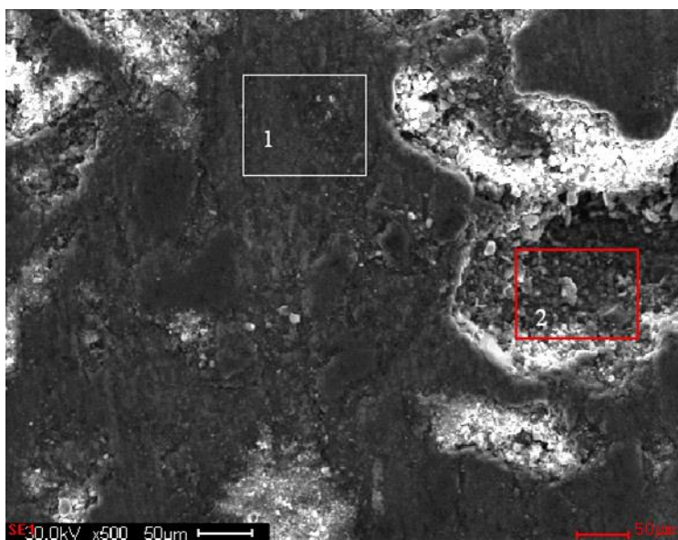
Рис. 2. Типичная структура синтезированной керамики \text{MgB}_2
