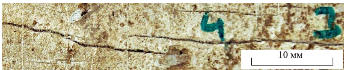
Рис. 6. Присоединение трещины вершиной к средней части соседней трещины
