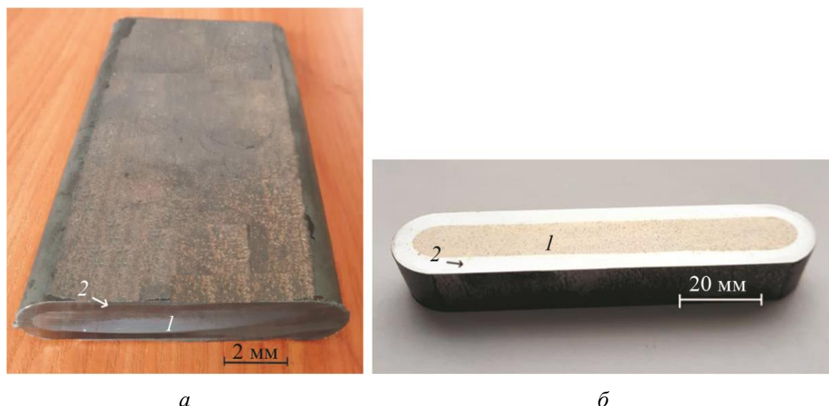
Рис. 2. Внешний вид сэндвич-пластины (а) и ее поперечное сечение (б); 1– композит Cu–Ti–C–В, 2 – стальная оболочка
