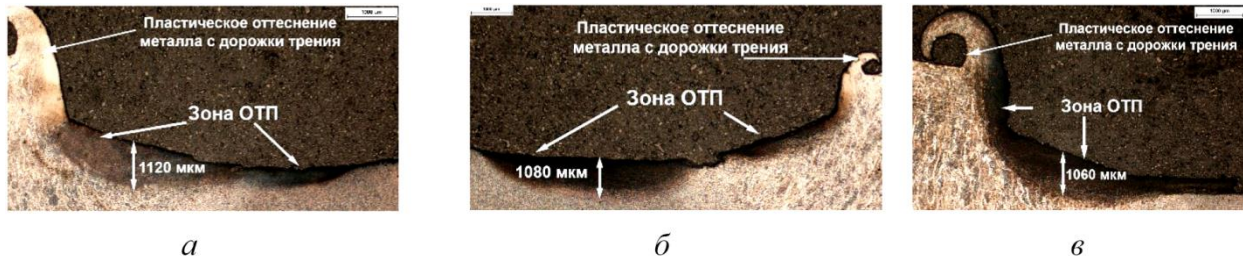
Рис. 3. Общий вид обработанной трением с перемешиванием околошовной зоны образцов: ОТП 50 (а); ОТП 75 (б); ОТП 100 (в)
