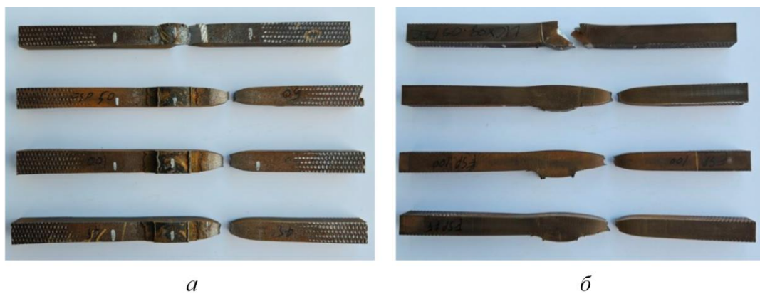
Рис. 8. Разрушенные образцы в процессе испытаний на растяжение: вид сверху (а); вид слева (б)
