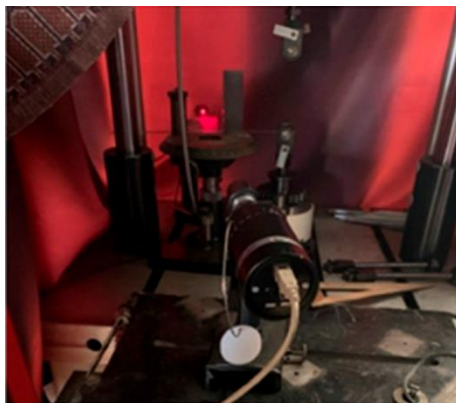
Рис. 2. Схема оптической установки: 1 – лазер; 2 – лазерное излучение; 3 – матовый рассеиватель; 4 – образец; 5 – линза; 6 – матрица телекамеры
