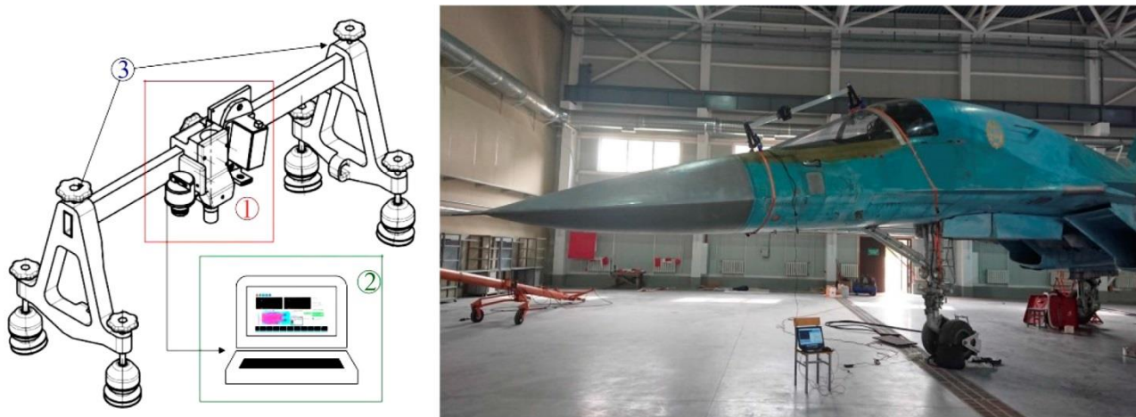
Рис. 6. Программно-аппаратный комплекс определения величины перемещения остекления из заделки по анализу параметров регистрируемых цифровых спекл-полей: 1 – оптоэлектронная система; 2 – ЭВМ с программным модулем обработки спекл-полей; 3 – оснастка для размещения оптоэлектронной системы на кабине самолета
