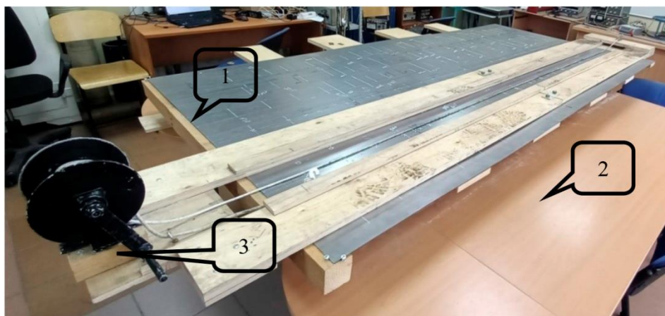
Рис. 1. Стенд для исследования магнитоупругих свойств стального листа при простом поперечном изгибе: 1 – исследуемый стальной лист (образец); 2 – платформа с подъемным механизмом, расположенным внизу под листом в его центральной части; 3 – устройство для полосового намагничивания и сканирования листа стали
