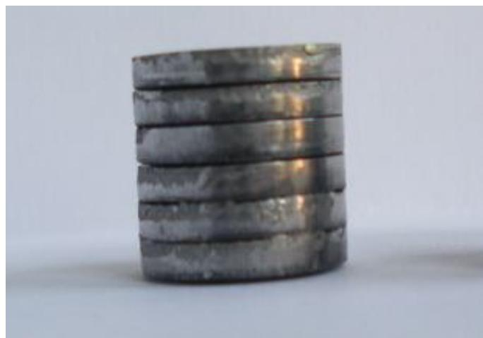
Рис.11. Общий вид составного цилиндрического образца перед испытанием
