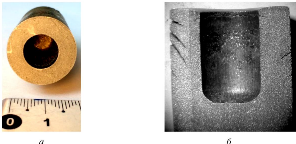
Рис. 11. Фотографии детали «стакан»: выдавливание с подпором (а); выдавливание без подпора (б) (деталь разрезана)
