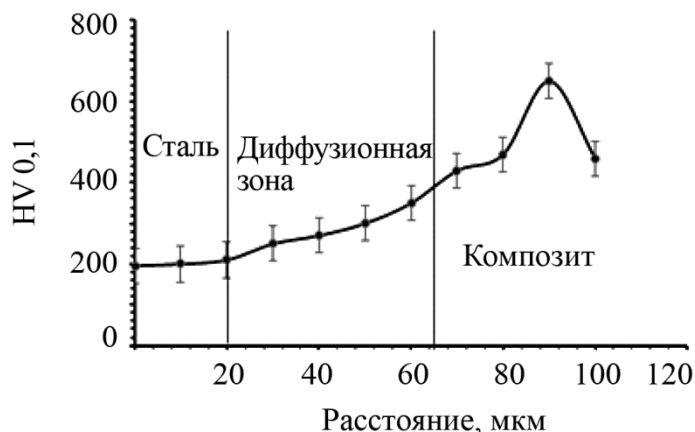
Рис. 5. Распределение микротвердости на границе стальной оболочки и композита Cu–Ti–C–B
