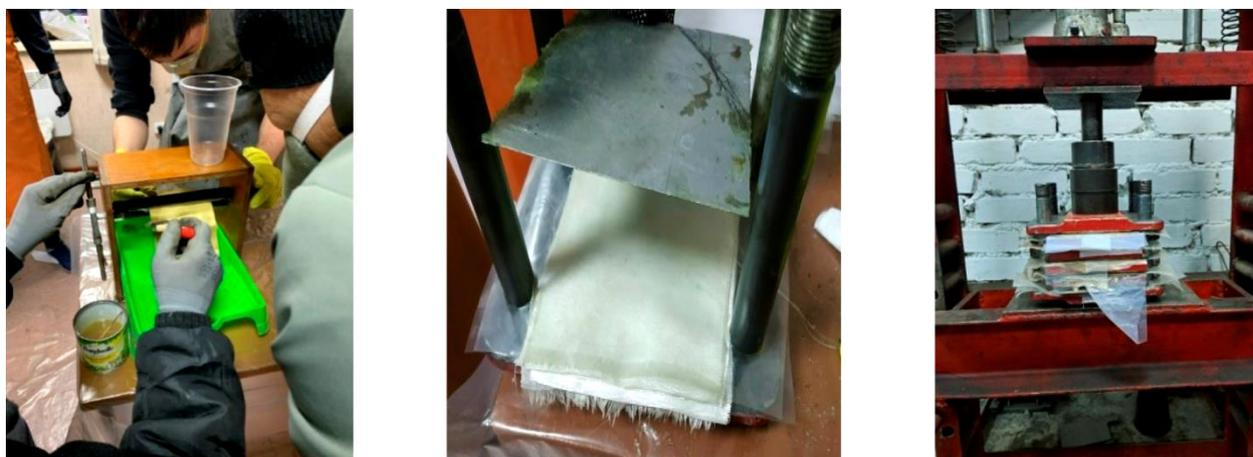
Рис. 1. Изготовление многослойных образцов из композиционных материалов
