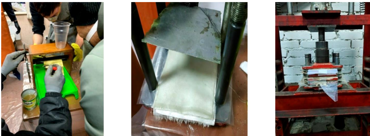
Рис. 1. Изготовление многослойных образцов из композиционных материалов
