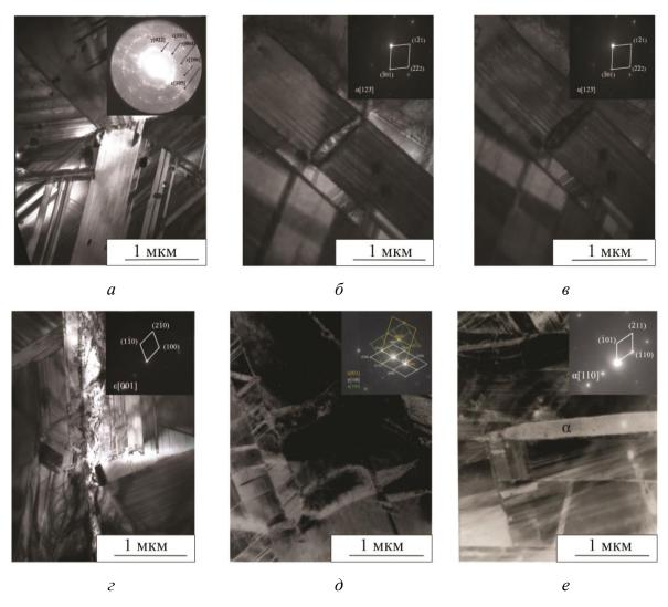
Рис. 6. ПЭМ-изображения стали 05Г20С2: a – исходное;  $\delta$  – зона плоскости I (рис. 1 a) (светлопольное изображение);  $\epsilon$  – зона плоскости I (темнопольное изображение);  $\epsilon$  – зона плоскости I (участок циклического разрушения);  $\epsilon$  – зона плоскости I (участок статического разрушения)
