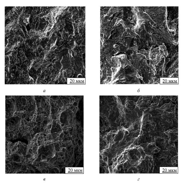
Рис. 5. Микростроение излома стали 05Г20С2: a – в зоне циклического разрушения ( $\Delta K = 18,5 \text{ М}\Pi a \times m^{1/2}$ );  $\delta$  – в зоне циклического разрушения ( $\Delta K = 30 \text{ M}\Pi a \times m^{1/2}$ );  $\epsilon$  – в зоне циклического разрушения ( $\Delta K = 43 \text{ M}\Pi a \times m^{1/2}$ );  $\epsilon$  – в зоне статического нагружения
