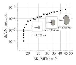
Рис. 3. Кинетическая диаграмма усталостного роста трещины в стали 05Г20С2
