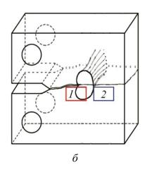
Рис. 1. Схема вырезки образцов: a — фольги для ПЭМ (плоскости 1, 2, 3);  $\delta$  — образцы для EBSD (1 и 2 — участки для вырезки образцов)
