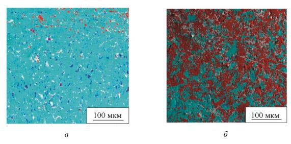
Рис. 7. Карты распределения фаз ( $\blacksquare - \alpha'$ ,  $\blacksquare - \gamma$ ,  $\blacksquare - \epsilon$ ): a - участок 1;  $\delta - \text{участок } 2$  (рис. 1  $\delta$ )
