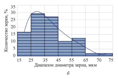
Рис. 2. Микроструктура стали 05Г20С2 в исходном закаленном состоянии: a — изображение;  $\delta$  — средний размер зерна
